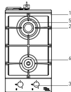
Все газовые варочные панели making Oasis everywhere (кроме моделей P-GEV, P-GEW, P-MEV, P-MEW, P-MEN) оснащены системой безопасности «Газ-контроль». На каждой горелке установлена система, которая автоматически прекращает подачу газа к горелке в случае, если пламя внезапно погасло.
